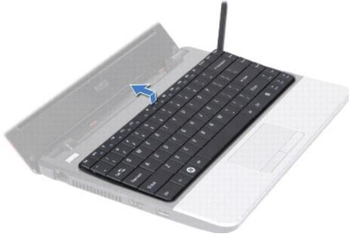
6. Heben Sie die Tastatur vorsichtig an, bis das Tastaturkabel sichtbar ist.
