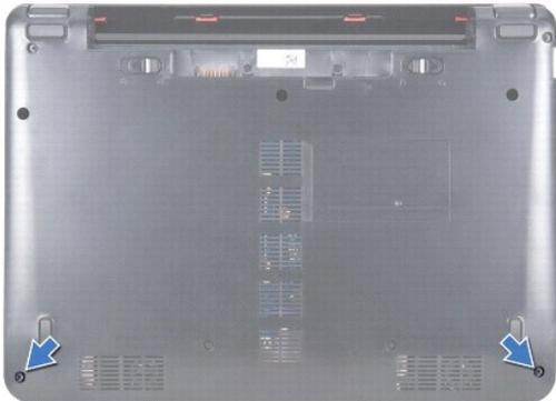
4. Drehen Sie den Computer um. Beginnen Sie an der rechten oder linken Seite und trennen Sie die Handballenstütze mit den Fingern oder einem Schlitzschraubenzieher von der Halterung der Handballenstütze.
